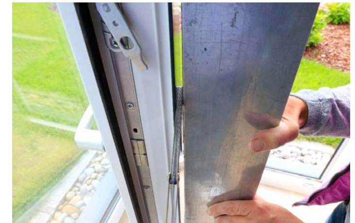
Werden die Profile bei der Extrusion stark gestreckt und im eingebauten Zustand stark erwärmt, ist die Verformung durch Rückschumpf gewaltig.
