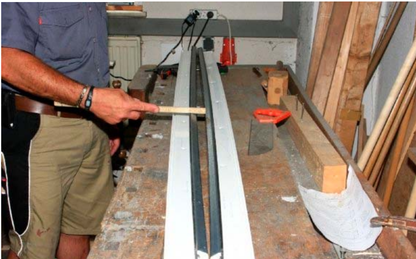
Die Profile werden durch die Sonne nur außen erhitzt, innen behalten sie ihre Temperatur, deshalb schrumpfen die Profile nur außen und schlagen einen Bogen nach innen.
